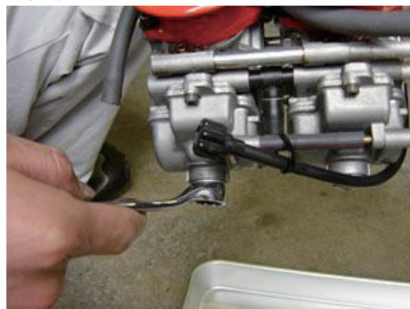
キャブレター本体をはずしたら写真NO12のようにフロート室のドレンボルトを緩めガソリンを抜きます。
