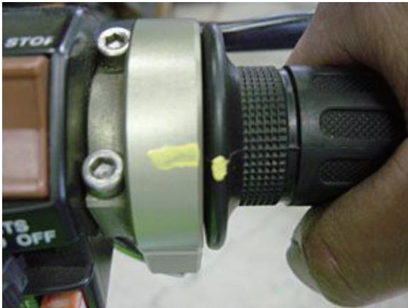
アクセルを開け閉めして加速ポンプから燃料を出したら写真NO5のようにほんの少しだけアクセルを開けセルを回すとかかりやすくなります。この時開けすぎるとかえってかかりにくくなるので注意が必要です。
