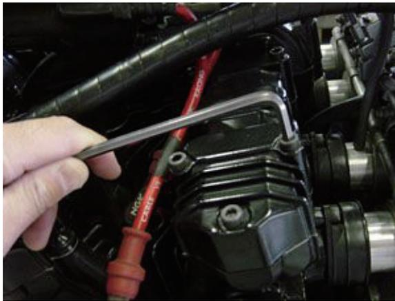
これはエンジンのヘッドカバーを締め付けているボルトをまし締めしているところです。
