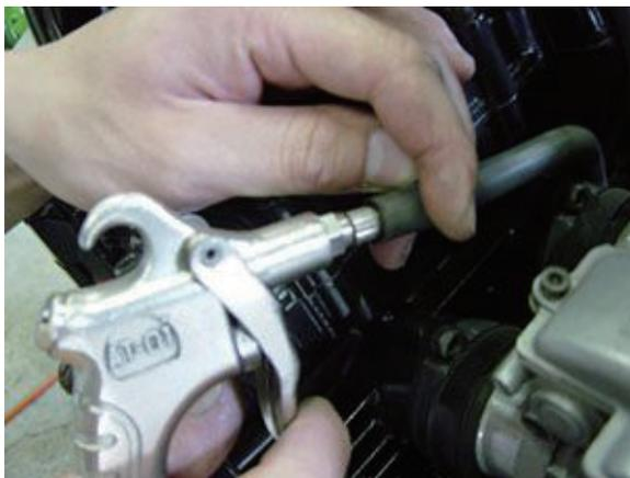
エアガンを使用する場合はいきなり強いエアで吹いてはいけません。先ほどのエアガンのタイプであれば弱くエアが出るように調整し、調整できないタイプであれば、エアがたくさんでないように握り加減を調整しながら写真NO8のように燃料ホースからエアを吹きます。いきなり強いエアで吹くとキャブレターを痛めることがありますので弱目からスタートします。
