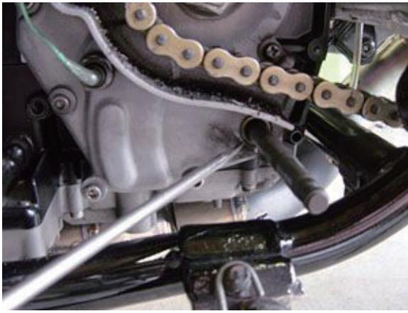
NO3はエンジンのフロントスプロケットカバーをはずした写真です。マイナスドライバー先端でさした心配ありませんが、たまにチェックをして確認してください。この写真では解りやすいようにカバーをはずしていますが、普段はカバーをつけたままで、下からのぞいて見てオイルのしずくがたれていなければ大丈夫です。
