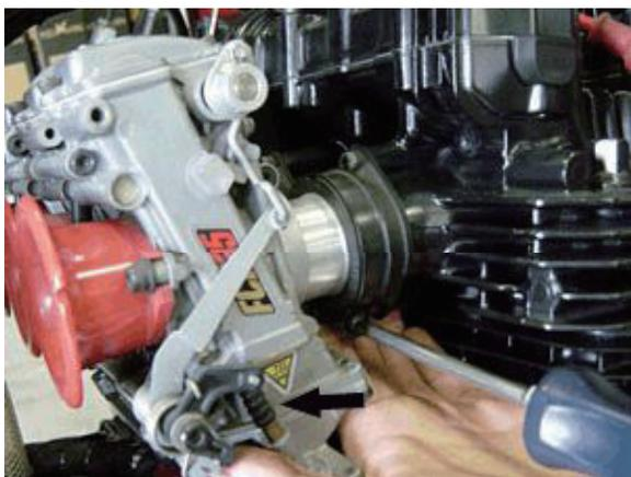
写真NO10のようにキャブレターを止めているインシュレーターバンドのボルトを4本緩め、キャブレターをはずします。
